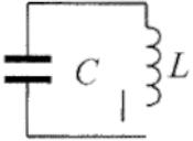
$\begin{cases} q(t) = q_{\max} \sin(\omega t + \varphi_0) \\ I(t) = \dot{q}_t = \omega q_{\max} \cos(\omega t + \varphi_0) = I_{\max} \cos(\omega t + \varphi_0) \end{cases}$ <p>Формула Томсона: <math>T = 2\pi\sqrt{LC}</math>, откуда <math>\omega = \frac{2\pi}{T} = \frac{1}{\sqrt{LC}}</math>.</p> <p>Связь амплитуды заряда конденсатора с амплитудой силы тока при свободных электромагнитных колебаниях в идеальном колебательном контуре: <math>q_{\max} = \frac{I_{\max}}{\omega}</math></p> |
